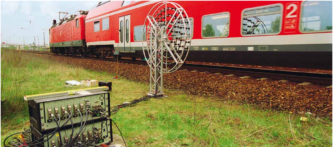
Mit sogenannten Freifeld-Arrays ermitteln Experten unter anderem, wie viel Lärm ein vorbeifahrender Zug bei verschiedenen Geschwindigkeiten verursacht.
